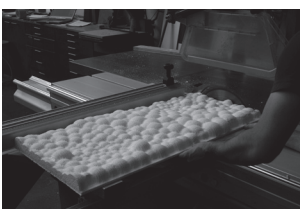
Zuschneiden der Styroporplatten in der Mobiliarwerkstatt
