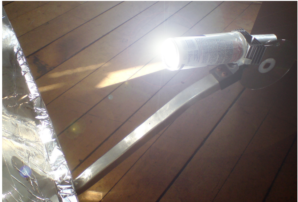
Dosen-Stirlingmotor im Fokus des konzentrierten Sonnenlichts
