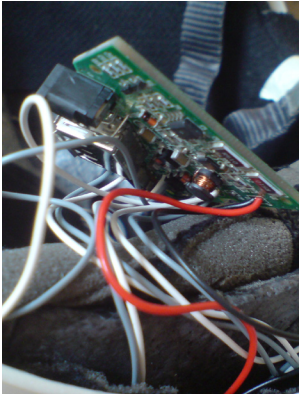
Einbauen der Elektronik im Polster des Helms
