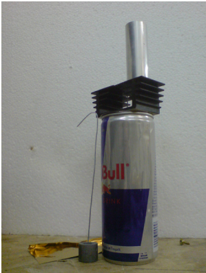
Arbeitskolben neben dem Büchsenzylinder mit Kühlelementen
